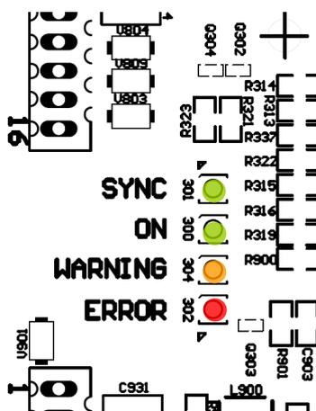
I 4 LED della scheda di controllo informano l'utente dello stato di esercizio dell'alimentazione di tratta:
